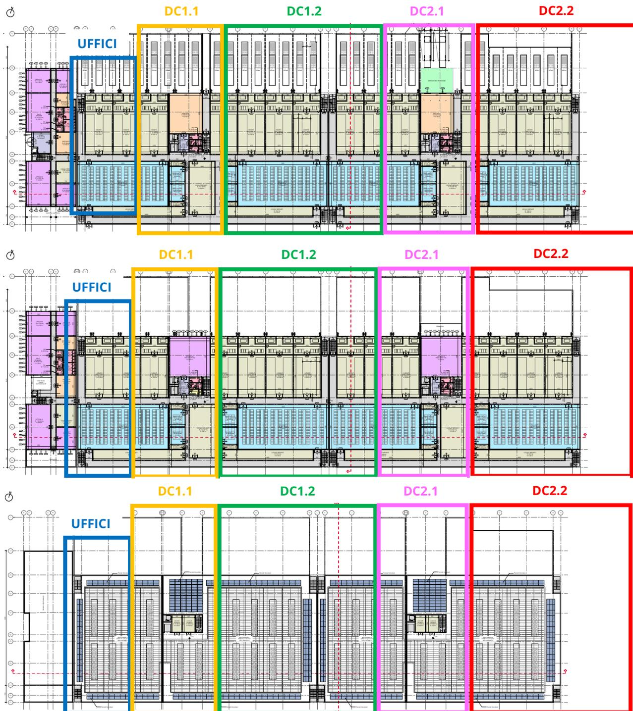
Gli edifici avranno fondazioni su pali, una platea di fondazione posta a quota 0 (senza piani interrati) e una struttura in elevazione realizzata con elementi prefabbricati in cemento armato precompresso (pilastri, travi e solai), completata con facciate in pannelli prefabbricati di calcestruzzo.
